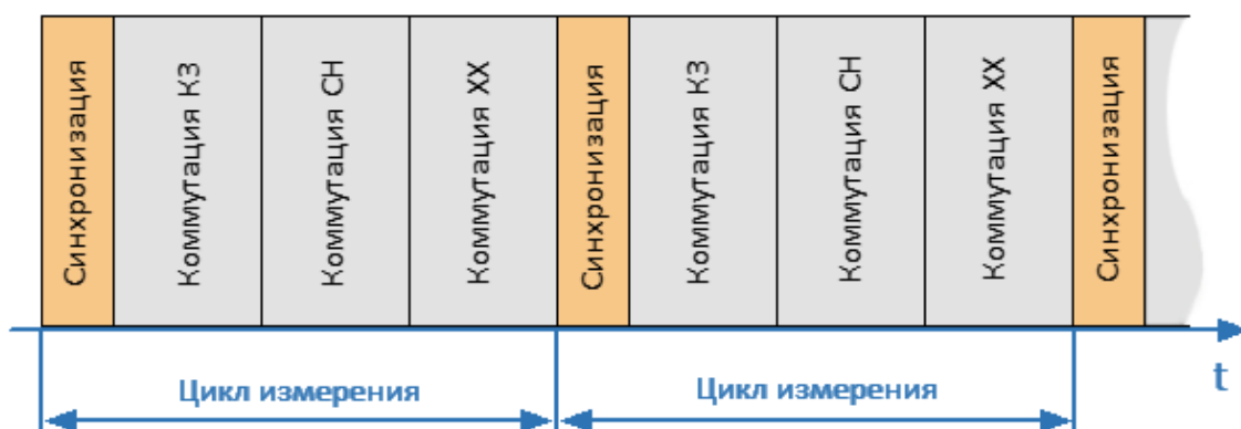
Рисунок 107 – Временная диаграмма рабочего цикла АКМ
