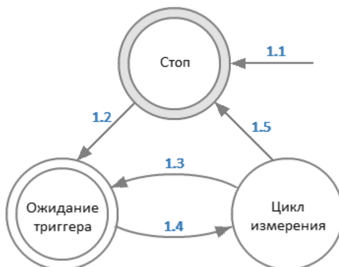
Рисунок 53 — Состояния и переходы измерителя
